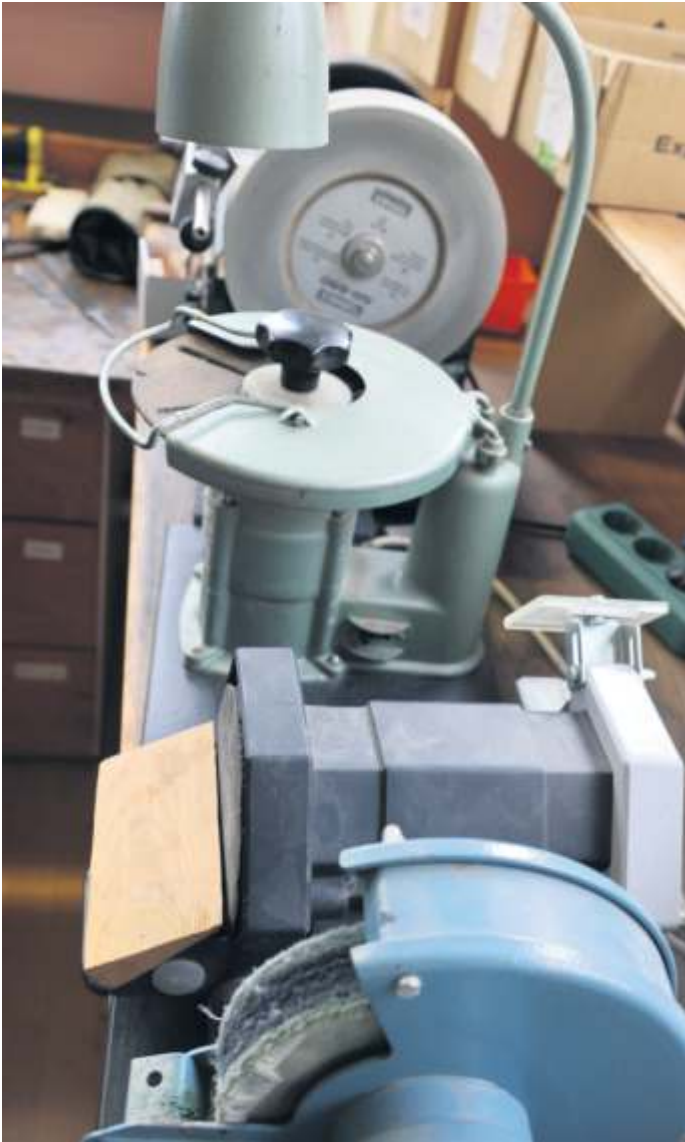
Zum Bau und zur Reparatur von Saiteninstrumenten sind umfangreiche Kenntnisse und Fertigkeiten sowie scharfe Werkzeuge notwendig, die in der Werkstatt von Thomas Hummel an diesen Schleifmaschinen geschliffen werden.
