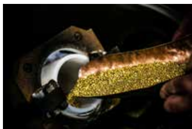
Um Gold zu legieren, werden bei Chopard Edel- und Beimetalle geschmolzen
